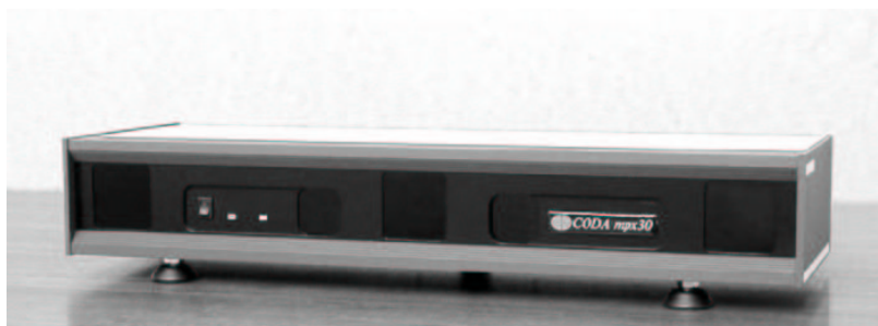
Figure 6.4 : Le dispositif de 3 caméras du système de Coda motion capture, copyright photo Charnwood Dynamics
