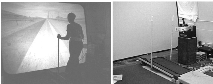
Figure 2.16 : Interfaçage comportemental par un tapis roulant asservi et un «guidon» pour se déplacer, photo Ecole des Mines de Paris
