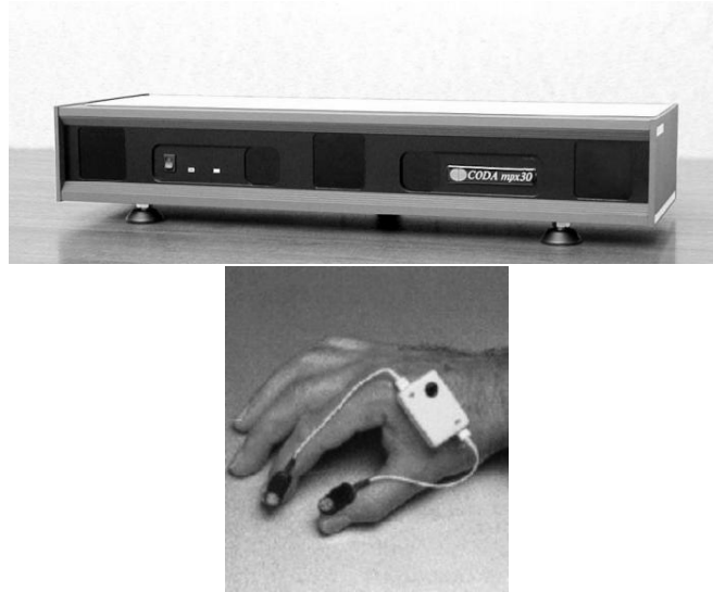
Figure 5.25 : Le dispositif de 3 caméras et deux cibles sur deux doigts du système Coda motion capture pour le suivi de doigts, copyright photos Charnwood Dynamics
