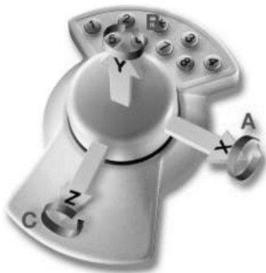
Figure 7.9 : La souris 3D Space mouse de 3Dconnexion, copyright photo 3Dconnexion
