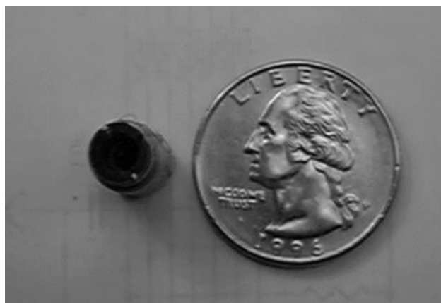
Figure 9.3 : Le tactor TDITAC8x9 de la société Transdimension, copyright photo Transdimension
