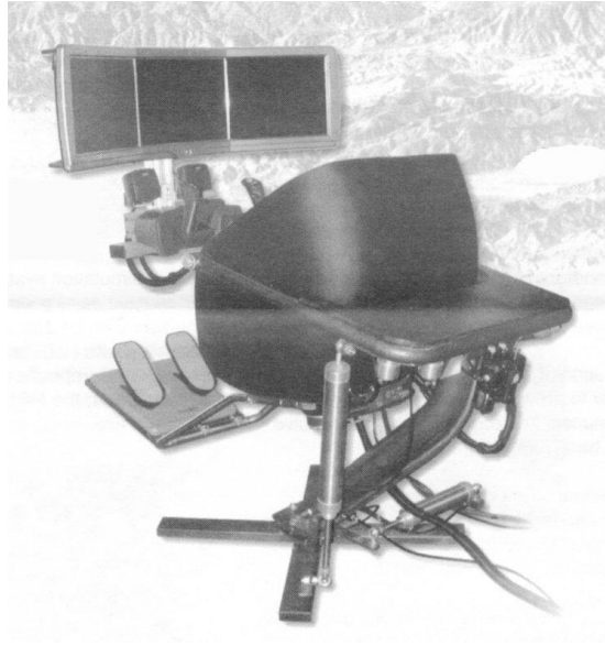
Figure 11.4: Le micro simulator de Panoram technologies avec 3 écrans, copyright photo Panoram Technologies
