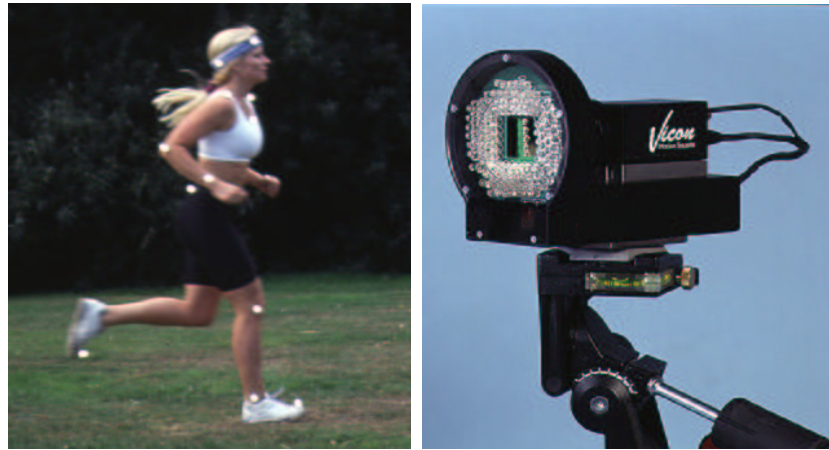
Figure 15.13 : Le système d'acquisition de mouvement commercialisé par la société Vicon, copyright photos Vicon
