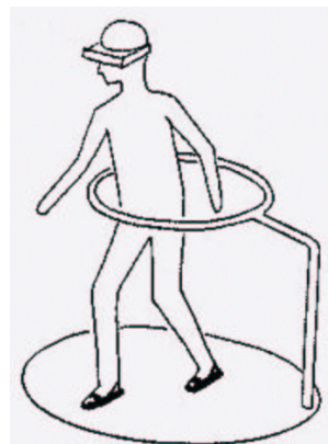
Figure 6.10 : Interface de locomotion à patins à roulettes
