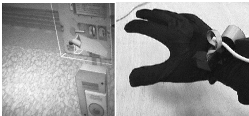
Figure 2.18 : Interface comportementale : gant de données pour manipuler le téléphone, l'aiguillage, etc., photo SNCF
