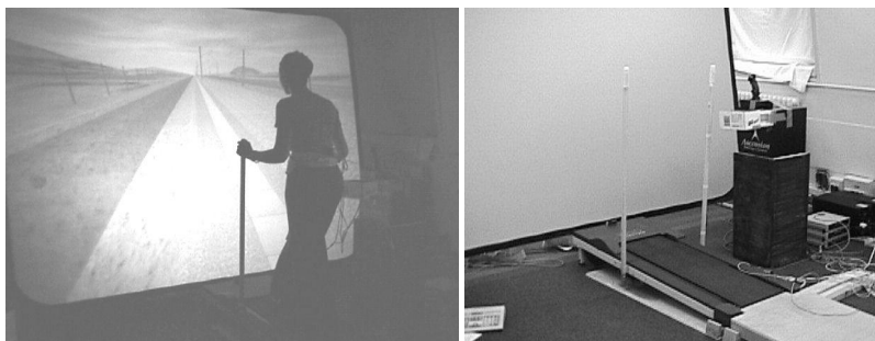
Figure 6.11 : Interface de locomotion : un tapis roulant asservi et un «guidon» pour se déplacer, photo Ecole des Mines de Paris
