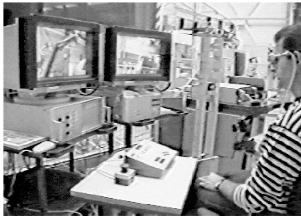
Figure 1.7 : Le robot téléopéré est affiché simultanément en images réelles en relief et en images de synthèse en relief, photo Ecole des Mines de Paris
