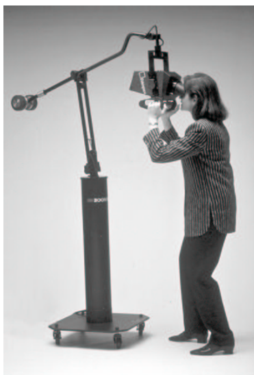
Figure 10.29 : Système BOOM HF de Fakespace Labs, copyright photo Fakespace Labs
