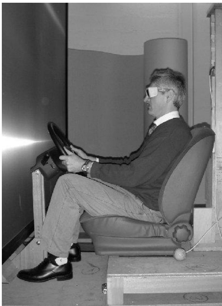
Figure 10.17 : Dispositif de visualisation pour l'Immersion Adaptée à un Véhicule, IMAVE (photo Ecole des Mines de Paris)
