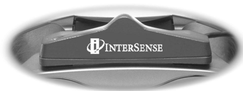
Figure 5.16: L'InterTrak2 à 3 ddl d'orientation à technologie inertielle d'InterSense, copyright photo SimTeam
