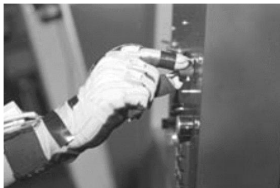
Figure 9.8 : Le gant et la platine mobile de boutons du système TOPIT, copyright photo CGSD Corporation
