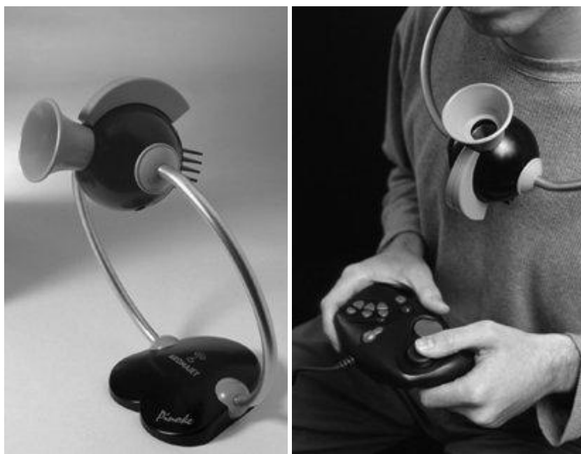
Figure 12.2 : L'interface olfactive portable Pinoke développée par AromaJet, copyright photo AromaJet
