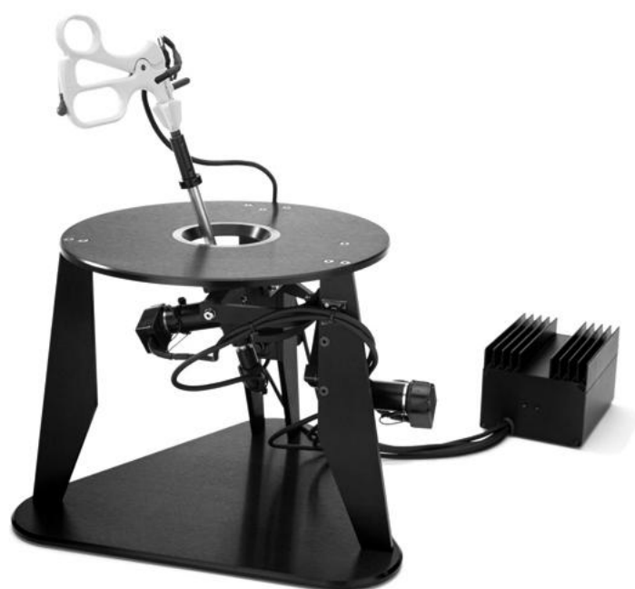
Figure 8.16 : L'interface à retour d'effort Impulse Engine de Immersion Corporation, copyright photo Immersion Corporation
