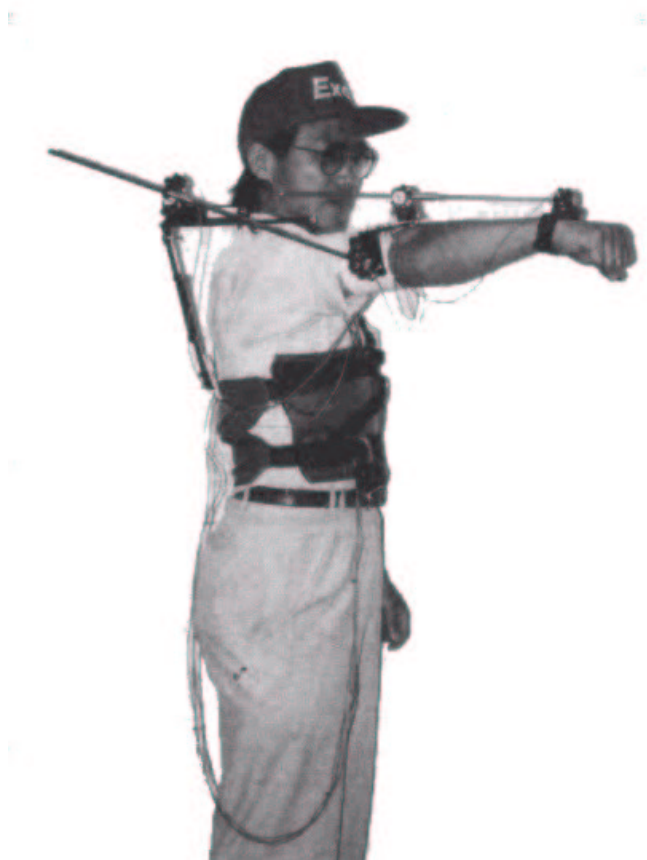
Figure 6.6: L'interface de localisation des membres supérieurs de Exos, copyright photo Exos
