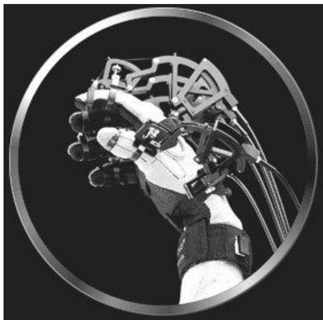
Figure 8.25 : Le gant de données à cinq retours d'effort CyberGrasp de Virtual Technologies, copyright Immersion S.A.
