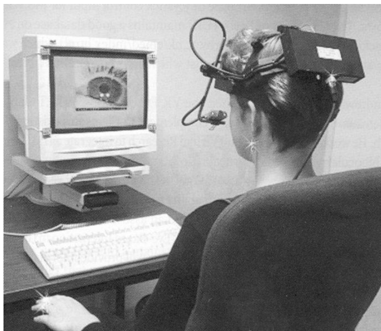
Figure 6.20 : L'oculomètre de SensoMotoric Instruments, copyright photo SensoMotoric Instruments
