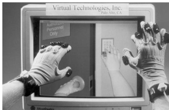
Figure 9.5 : Le gant de données Cyberglove avec retour vibro-tactile Cybertouch de Virtual Technologies, copyright photo Immersion S.A.
