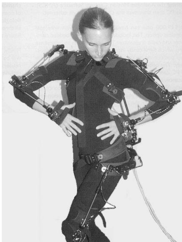
Figure 6.2 : La capture de mouvement par exosquelette Gypsy de Analogus Corporation, copyright photo Analogus Corporation
