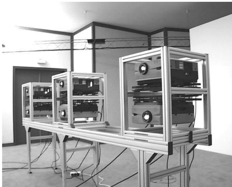
Figure 2.12 : Réalisation de l'écran avec six vidéoprojecteurs LCD (3072x1536 pixels au total), photo Ecole des Mines de Paris
