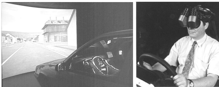
Figure 1.1 : Simulation de la conduite d'une voiture avec visiocasque ou sur écran de simulateur, copyright Photo PSA Peugeot Citroën
