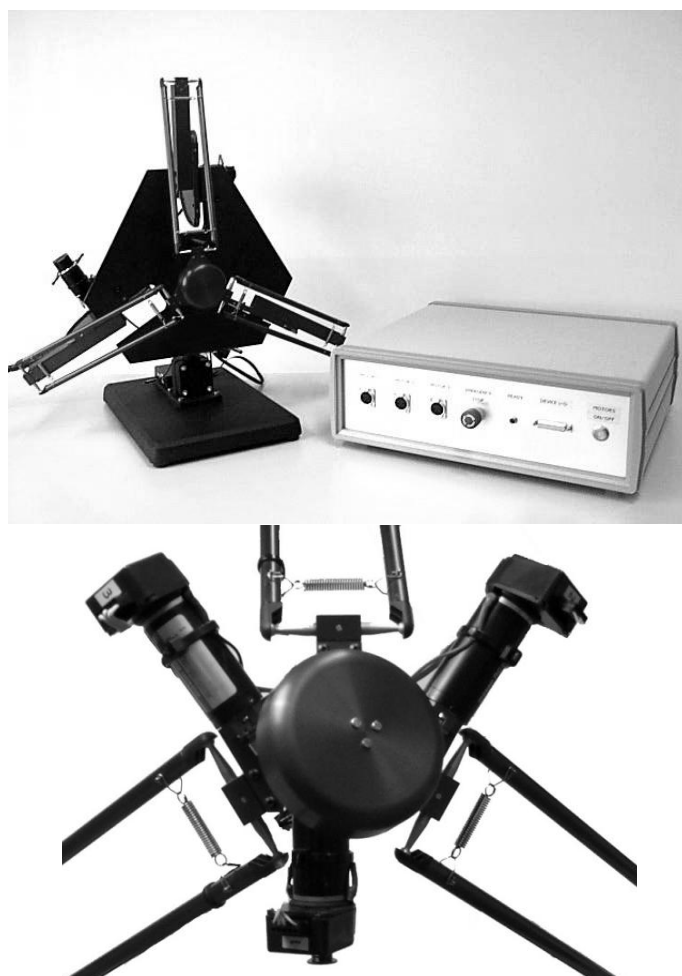
Figure 8.15: L'interface à retour d'effort Delta haptic Device de ForceDimension, copyright photos ForceDimension
