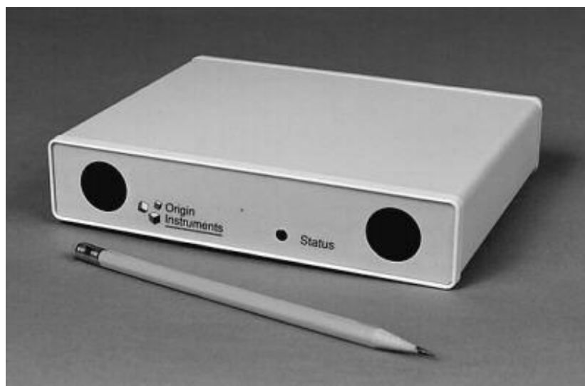
Figure 5.22 : Le traqueur optique DynaSight pour le suivi de mouvement de paires de lunettes, copyright photo Origin Instruments Corporation
